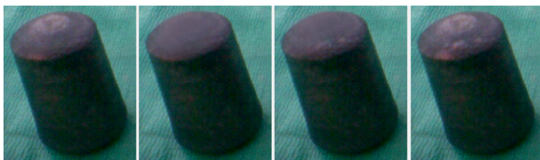
1-расм. «ДТЗ» МЧЖ да юқорихромланган оқ чўянлардан тайёрланган куйма цилипебсларнинг умумий ташқи кўриниши
